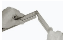
1. Spojte profily dvoma spojovacími rohmi
