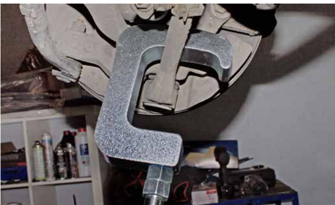
DEMONTAGE VON ACHS-VERBINDUNGEN mit Art.-Nr. 103993
