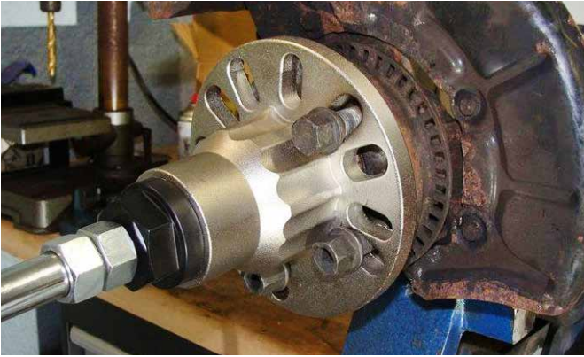
RADNABENABZIEHER Art.-Nr. 23047 mit Adapter, Art.-Nr. KT10058 (für Ford Transit: Art.-Nr. 106409 mit KT10058)
