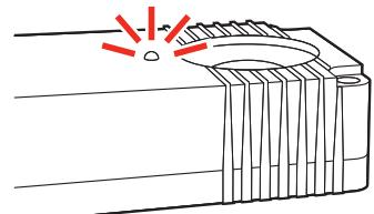
**CZ | Blikající LED:** Modul v provozu. Tuna aktivní!
